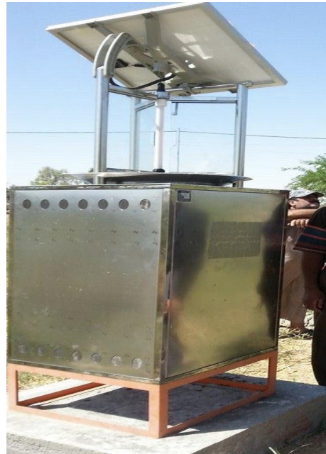
شكل رقم (5) المصائد الضوئية (Magna Trap مع مصباح بطول موجة 320-420 نانومتر ، Russell IPM )
